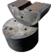
شکل ۴- جداسازهای باربر (استنکی) - فولادی که لایه‌های فولادی و وایر آن به‌صورت یک در میان در کنار هم قرار گرفته‌اند.
